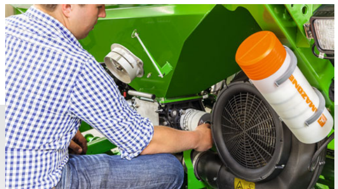
Une bonne accessibilité des bobines de dosage facilite leur changement
