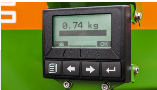
Etalonnage par le biais du TwinTerminal 3.0
